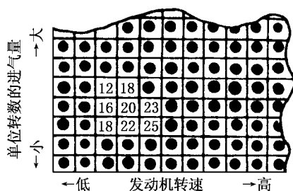
图 源源源 平常行驶时的基本点火提前角
